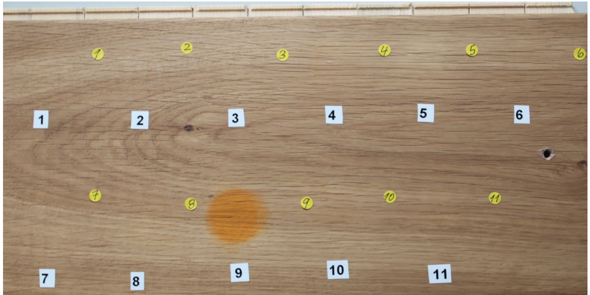
Abb. 1. Atramex 7701 Partec ES 2010 auf Holzparkett nach 48 h Rücktrocknung (Benetzungstest - weiße Markierungen, Eintrocknungstests - gelbe Markierungen)
